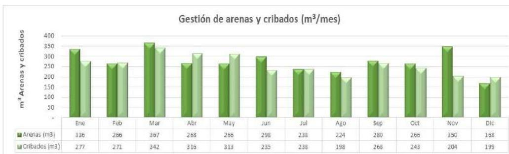
En la anterior gráfica la tendencia es bimodal respecto a las arenas y se ha identificado comportamiento acorde al régimen de lluvias, la porción del alcantarillado combinado de la zona aferente impacta en el ingreso de arenas a la PTAR.
